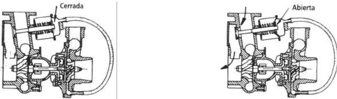
Turbo de geometría variable por control doble :
